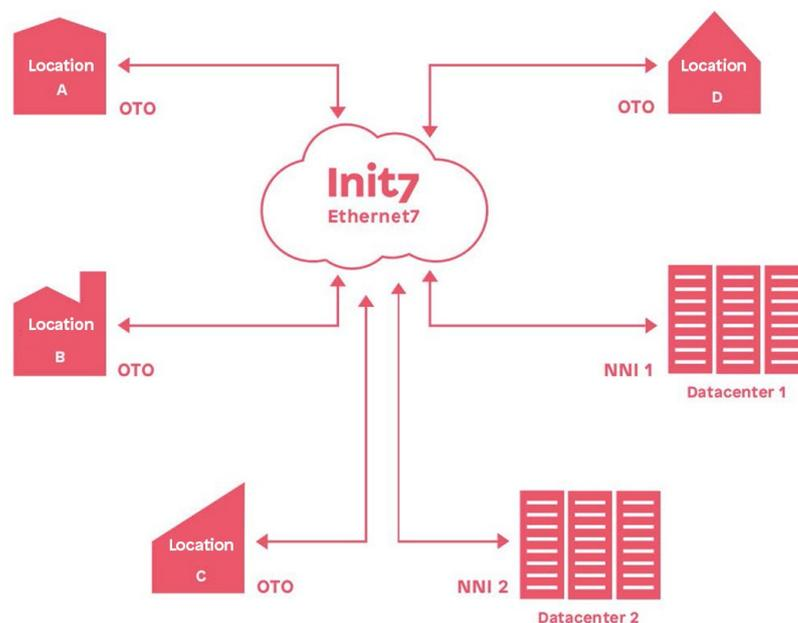
In oltre 50 centri dati carrier-neutral in Svizzera e in Europa, Ethernet7 può essere fornito al cliente come NNI (Network-Network-Interconnect). L'elettronica attiva (livelli 2 e 3) è gestita interamente da Init7 stessa; non vengono utilizzati servizi di rivenditori.
